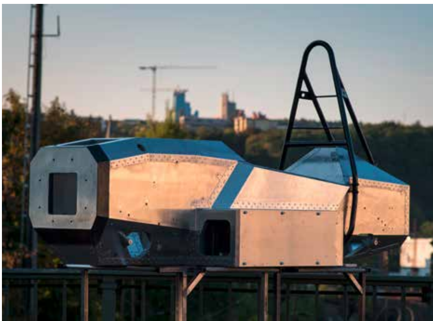
Nachhaltiger als Carbon: Chassis aus Aluminium
